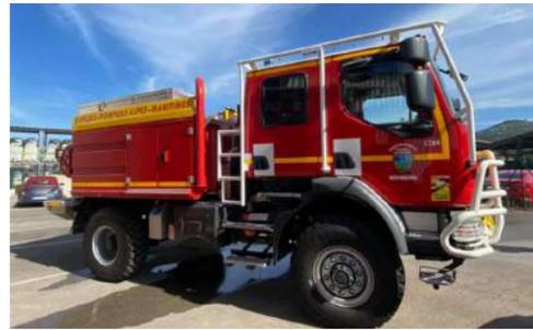
Le véhicule sert d'attaque pour des feux naissants ou violents, de protection de points sensibles et de protection du personnel en situation périlleuse grâce à son système d'auto-arrosage de la cabine. Il est aussi plus facilement identifiable grâce à sa couleur jaune en haut de la citerne lors des feux avec fumée.
